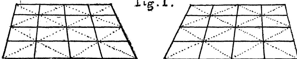
Un autre principe du dessin stéréoscopique, c'est que dans la représentation d'une figure en relief les faces du côté d'un œil doivent être élargies ; le contraire a lieu quand la figure doit se présenter en creux.
