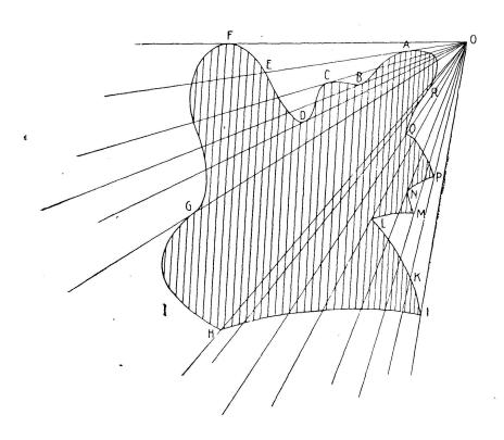
I. — Menons à la section l tous les rayons visuels tangents. En faisant varier le plan sécant, de manière à engendrer au moyen de la ligne l la surface tout entière, le lieu des points de contact obtenus dans chaque plan sécant est le collier de  $\alpha$  pour l'œil O (n° 2) ou pour une droite d parallèle aux rayons visuels.
