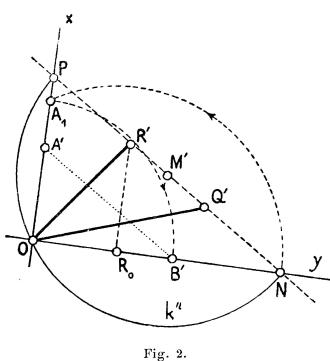
l'hyperbole et ses diamètres conjugués, nous donnons la construction suivante des axes, privée de toutes les lignes auxiliaires superflues (fig. 2).
