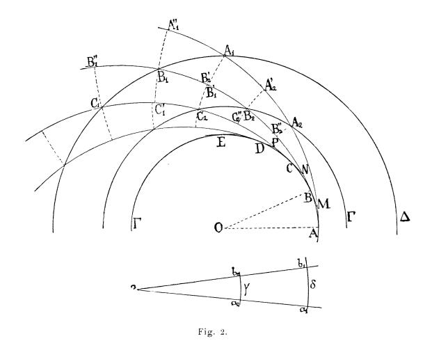
Avec les mêmes centres décrivons les arcs A<sub>2</sub>B"<sub>2</sub>, B<sub>2</sub>C"<sub>2</sub>.... et les arcs B<sub>1</sub>A"<sub>1</sub>, C<sub>1</sub>B"<sub>1</sub>...; nous obtenons de même
