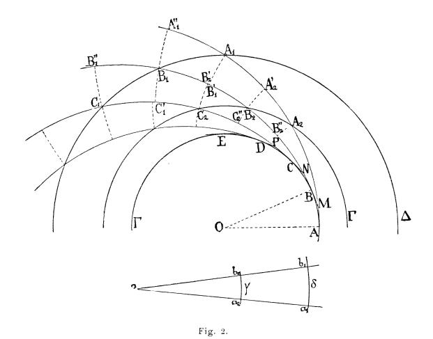
Avec les mêmes centres décrivons les arcs  $A_2B''_2$ ,  $B_2C''_2$ .... et les arcs  $B_1A''_1$ ,  $C_1B''_1$ ...; nous obtenons de même
