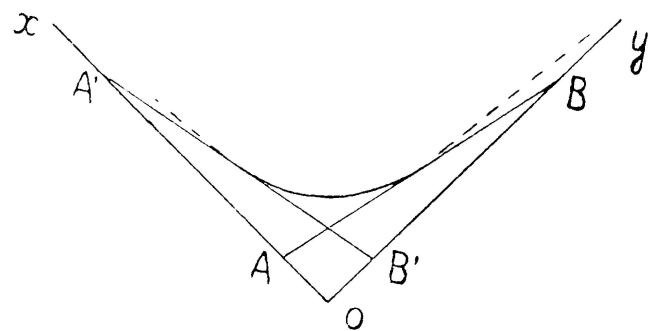
Si donc on prend une cuve prismatique, contenant un volume  $v$  de liquide et dont la section normale déterminée par un plan vertical est  $xOy$ , et si l'on fait pivoter la cuve autour de l'arête horizontale passant par O, la surface libre du liquide enveloppera un cylindre hyperbolique dont les génératrices sont parallèles à cette arête. Toute section normale sera une branche d'hyperbole, si l'on fait varier  $v$  on obtient des hyperboles homothétiques.
