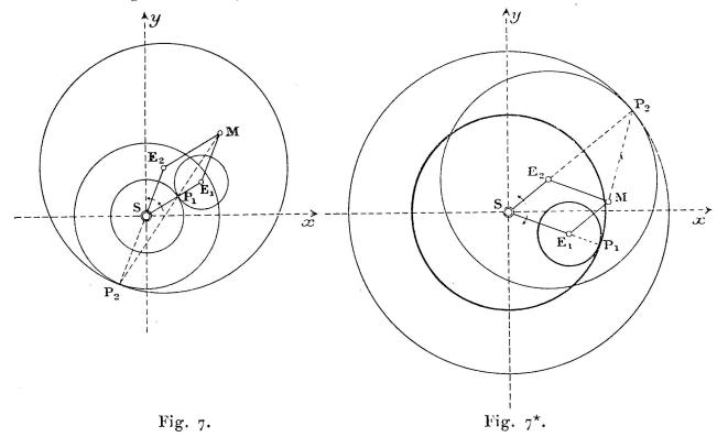
6. Si l'on réunit les figures 5 et 6 construites pour le même instant t\* en une seule de façon à rétablir le parallélogramme primitif, les points P<sub>4</sub>, P<sub>2</sub> et M sont en ligne droite (fig. 7).
