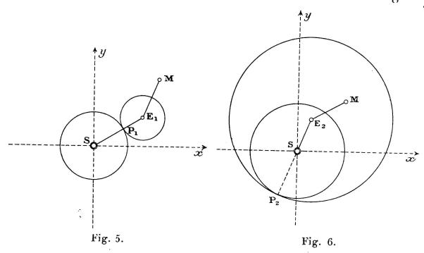
extérieurement de centres S et E<sub>1</sub> et de rayons a et b (fig. 5). Cela nous donne une troisième génération cinématique des courbes cycloïdales, qui est d'ailleurs la plus connue.
