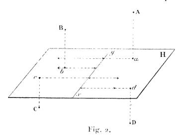
une droite quelconque xy dans le plan II, puis mener par  $a, b, c, d, \ldots$  des perpendiculaires à xy et prendre les cotes, sur
