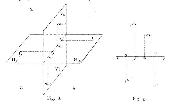
au-dessus de la ligne de terre, si le point est dans  $V_s$  (point M); au-dessous de la ligne de terre, si le point est dans  $V_i$  (point N). Les réciproques sont vraies.
