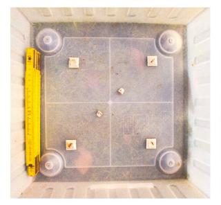
Abb. 2. Der Boden der Box, als Abstandhalter wurden Türstopper-Gummis verwendet; der Gittereinsatz darf nicht direkt auf dem Boden stehen. Massstab 22 cm.
