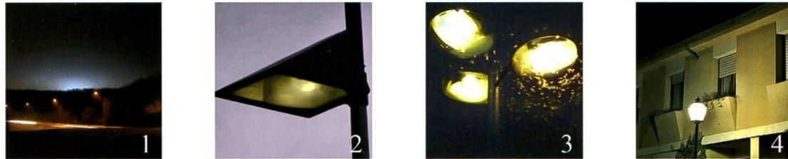
Abb. 1: Dieses Bild stellt keinen Sonnenaufgang hinter dem Wald dar sondern zeigt die Auswirkungen einer schlecht eingerichteten Sportplatzbeleuchtung. Die massive Lichtabstrahlung in den Nachthimmel ist eine unnötige Energieverschwendungen.
