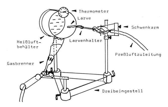
Abb. 1. Schemazeichnung des Heißluftpräpartionsgerätes.
