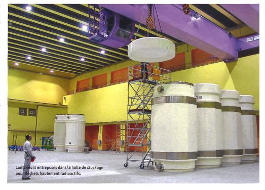
thermique, pour une utilisation économiquement intéressante. Une partie des conteneurs a déjà perdu plusieurs degrés de température. «A cause de cette perte de chaleur qui n'est pas régulière et le fait que la température extérieure des cylindres ne soit pas assez élevée, celle-ci n'est pas utilisable», explique Hösli.
