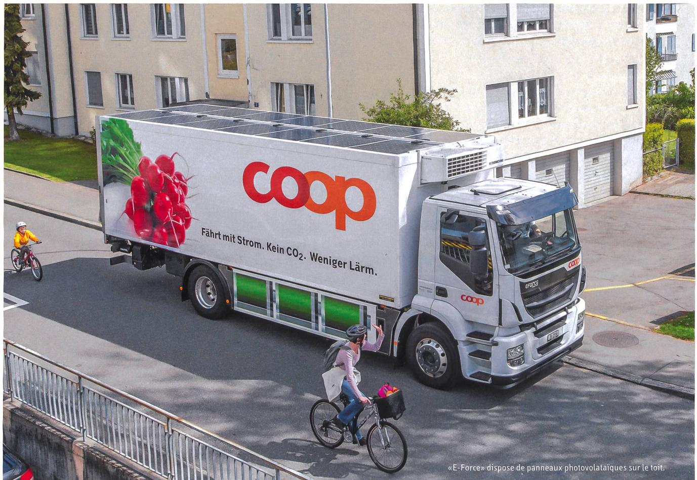
«E-Force» dispose de panneaux photovoltaïques sur le toit.
