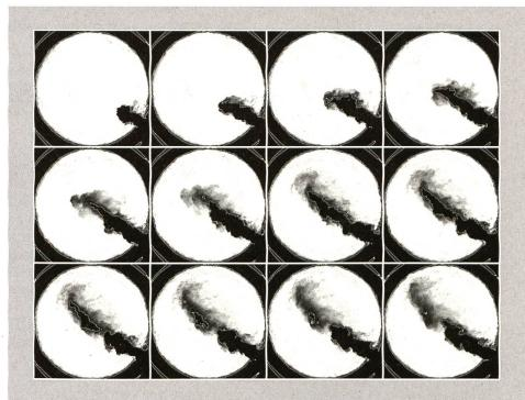
Visualisation du jet de diesel à l'intérieur de l'installation d'essai à des conditions de 90 bars et 930 kelvin.
