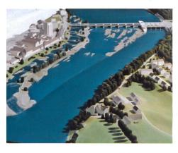
Modèle de la nouvelle centrale hydroélectrique avec le cours d'eau de frai et de montaison ainsi que les passes à poissons. La nouvelle usine hydroélectrique frontière de Rheinfelden sur le Rhin est un exemple révélateur de l'utilisation optimale de l'énergie hydraulique: comparativement à l'ancienne centrale, l'installation commune germano-suisse triple quasiment la production d'énergie tout en améliorant la situation écologique du délicat paysage fluvial.
