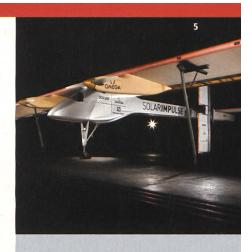
ailes sans fin et sur le stabilisateur horizontal sont réparties 11 628 cellules solaires en silicium monocristallin qui viendront alimenter en énergie les quatre moteurs de dix chevaux chacun de l'avion. Pour permettre le vol de nuit, de l'énergie sera stockée pendant la journée dans les 400 kilos de batteries au lithium polymère embarquées. Une structure ultra légère en matériaux composites vient compléter ce petit bijou d'innovation qu'est le Solar Impulse HB-SIA.
