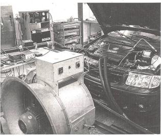
Le moteur au gaz naturel pour le «Clean Engine Vehicle» tourne sur le banc d'essai.
