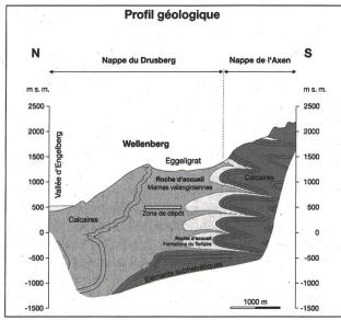
Profil du Wellenberg, perpendiculaire aux grandes structures géologiques. La roche dans laquelle le dépôt serait creusé au niveau de la vallée est formée de marnes valanginiennes et tertiaires. Les investigations menées ont montré la réelle étanchéité de cette roche argileuse. Quant aux traces de nappe phréatique trouvées dans la région potentielle du dépôt, elles sont enfouies dans la montagne depuis plus de 10 000 ans et sans aucun contact avec la surface.
