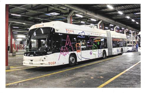
Seit Dezember 2017 bedienen die TOSA-Busse die Linie 23 der TPG in Genf. Die über 18 Meter langen Elektrobusse haben Platz für je über 130 Passagiere, da alle Ladekomponenten auf dem Dach installiert sind. Auf einer Strecke von 600'000 Kilometern spart das TOSA-System gegenüber Dieselbussen jährlich bis zu 1000 Tonnen CO<sub>2</sub> und rund 30 Prozent der Kosten ein. Eine wirtschaftlich rentable Lösung für die Stadt der Zukunft.
