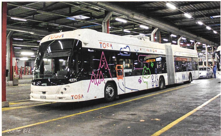
Seit Dezember 2017 bedienen die TOSA-Busse die Linie 23 der TPG in Genf. Die über 18 Meter langen Elektrobusse haben Platz für je über 130 Passagiere, da alle Ladekomponenten auf dem Dach installiert sind. Auf einer Strecke von 600'000
