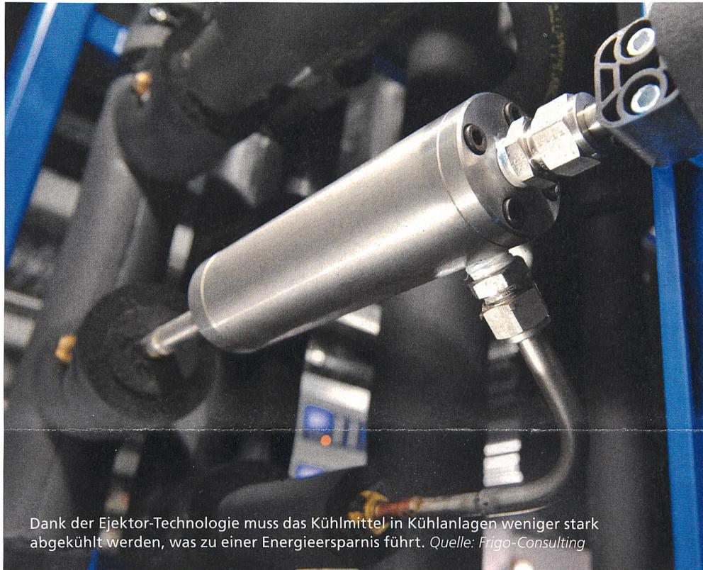
Dank der Ejektor-Technologie muss das Kühlmittel in Kühlanlagen weniger stark abgekühlt werden, was zu einer Energieersparnis führt. Quelle: Frigo-Consulting
