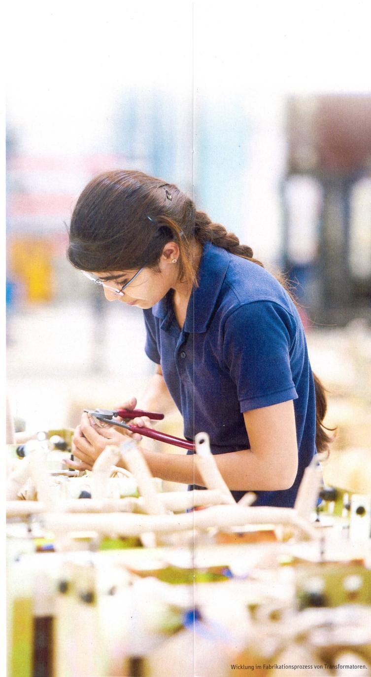
Wicklung im Fabrikationsprozess von Transformatoren.
