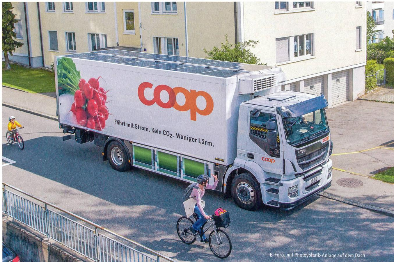
E-Force mit Photovoltaik-Anlage auf dem Dach
