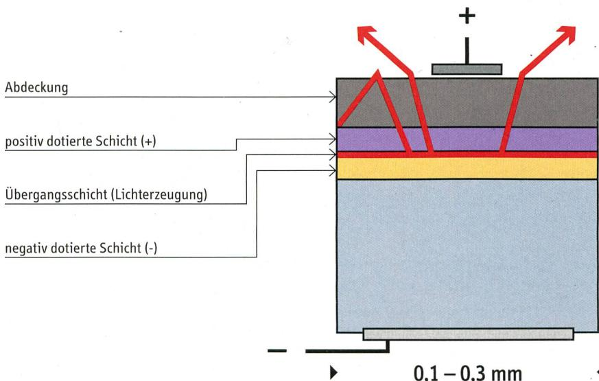
In einer Übergangsschicht werden diese Löcher durch überschüssige Elektronen gefüllt.
