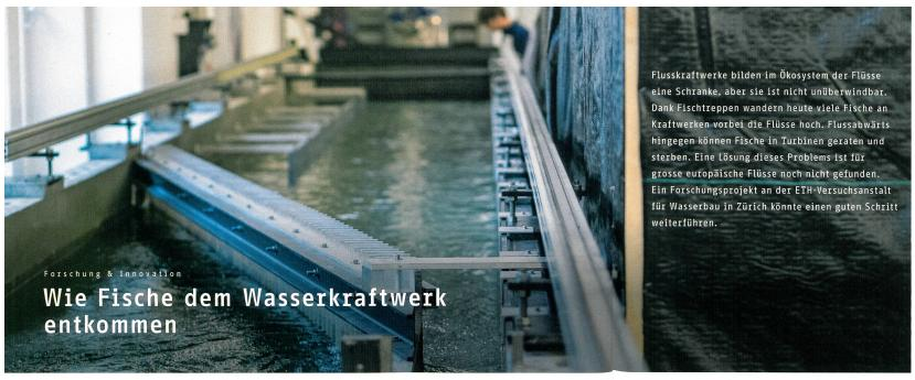
Vor dem Leitrechen - hier von der «Kraftwerkseite» fotografiert - bildet sich eine hochturhulente Strömung. Sie soll die Fische durch den schmalen Kanal rechts in den Fisch-Bypass führen.
