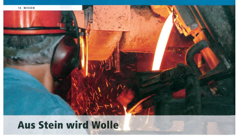
Steinwolle ist ein Naturprodukt aus Stein und eignet sich hervorragend für Wärme-, Brand- und Schallschutz. Mit einem Marktanteil in der Schweiz von knapp 18 Prozent spielt Steinwolle auch bei der Wärmedämmung des Dachsstuhls eine wichtige Rolle. In Flums entsteht die dämmende Steinwolle aus Basaltgestein aus den Alpen.
