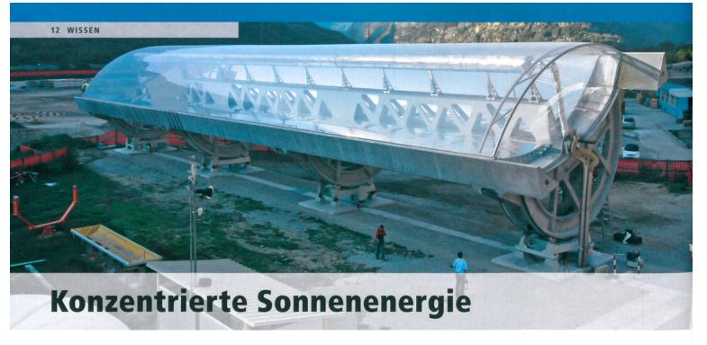
Mitte Oktober 2009 präsentierte die schweizerische Airlight Energy SA in Biasca im Tessin ihren dritten Prototyp eines solarthermischen Konzentrators. Die Entwicklung dieses Kernstücks eines konzentrierenden solarthermischen Kraftwerks wurde durch das Bundesamt für Energie unterstützt.
