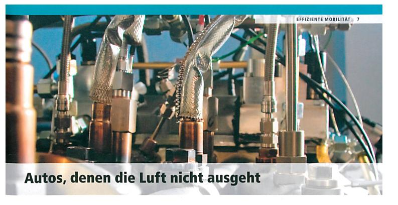
Das Team von Professor Lino Guzzella an der ETH Zürich hat als Weltpremiere einen kostengünstigen pneumatischen Hybridmotor entwickelt. Bei Mehrkosten von nur 20 Prozent im Vergleich zu herkömmlichen Motoren erreicht er eine Energieeinsparung von bis zu 30 Prozent. Zur Weiterentwicklung des Motors wird nun ein industrieller Partner gesucht.
