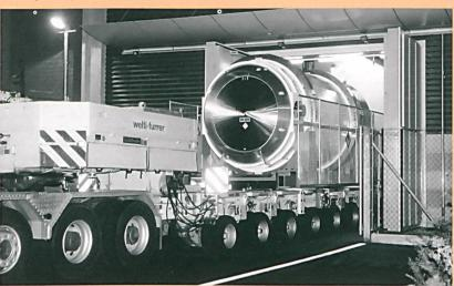
Überwacht von der HSK: Zum Abtransport werden die abgebrannten Brennelemente in mächtige Stahlbehälter verpackt.
