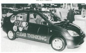
Der Toyota Prius ist das erste serienmässige Hybrid-Auto. Mit einem kombinierten Benzin-Elektro-Antrieb schluckt es im Schnitt um die 5 l/100 km.
