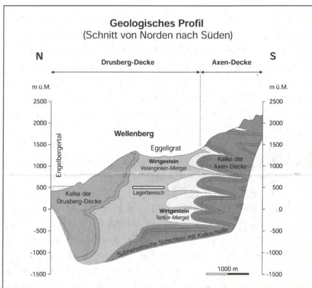
Profil durch den Wellenberg, senkrecht zu den geologischen Hauptstrukturen. Das Wirtgestein, in welches das Lager auf Talniveau zu liegen käme, besteht aus Valanginien- und Tertiär-Mergeln. Aufgrund bisheriger Untersuchungen ist dieses tonige Gestein sehr wasserdicht. Die im potenziellen Lagerbereich vorgefundenen Spuren von Grundwasser sind sehr alt – sie sind seit mehr als zehntausend Jahren im Berg eingeschlossen und ohne Kontakt zur Erdoberfläche.
