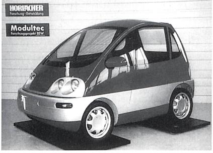
Dank modular zusämmengebauten Kunststoffelementen ist das Auto leicht und braucht weniger Energie.
