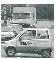
zurückgelegt. Der durchschnittliche Energieverbrauch lag bei 24,2 kWh/100 km.
