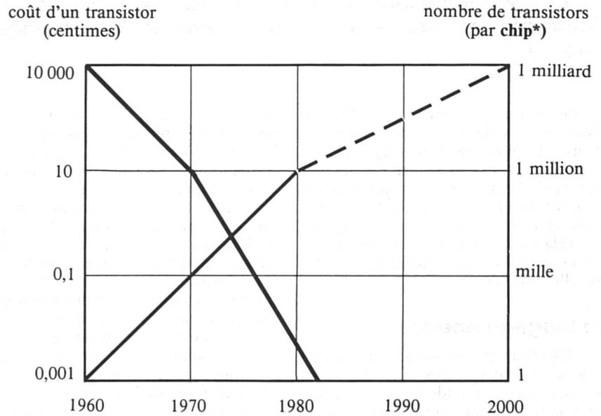
\* chip : plaquette de cristal de silice de 40 mm<sup>2</sup>
