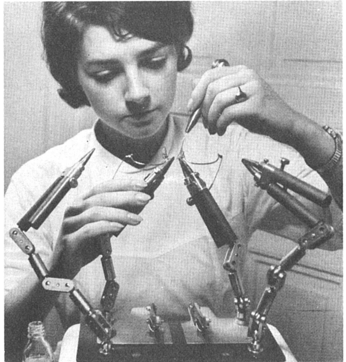
Soudage d'une monture
