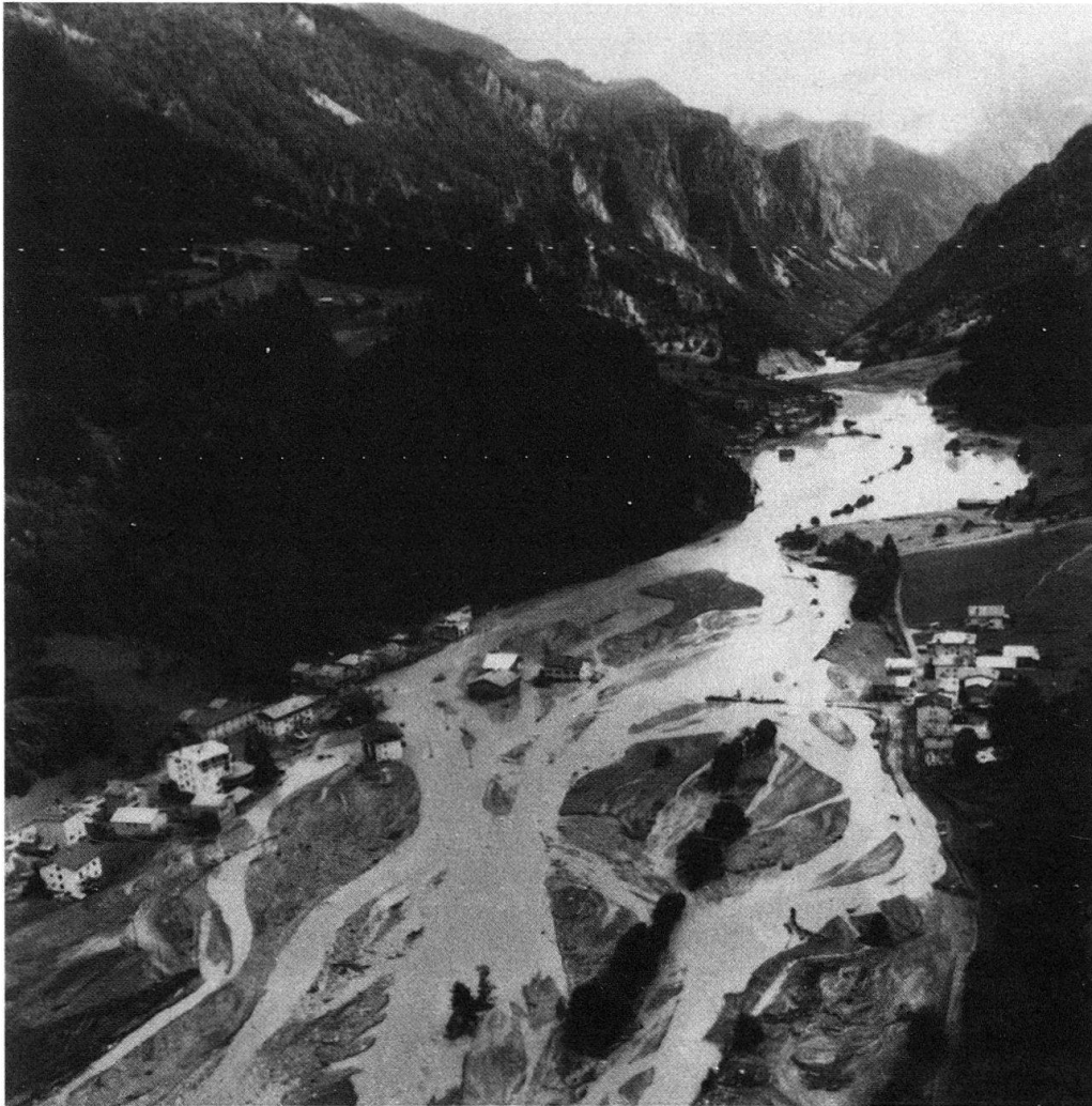
Fig. 3. Der Flachsee im Talboden von San Antonio Morignone (Links unten) nach dem Unwetter vom 18. Juli 1991. Blick talabwärts. Der Murgang aus dem Val Pola (rechts oben) hat die Adda aufgestaut. Aufnahme: kurz vor dem Bergsturz.
