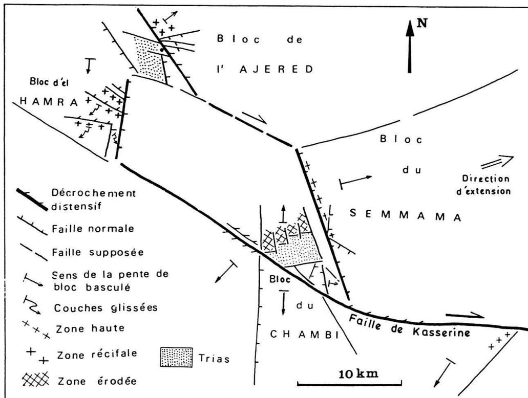
Fig. 10. La structuration anté-vraconienne dans la région de Kasserine. Les relations entre la faille majeure de Kasserine et les failles d'ordre inférieur, les extrusions de Trias, les domaines élevés et les pentes de blocs basculés suggèrent un mouvement distensif dextre de l'accident majeur.
