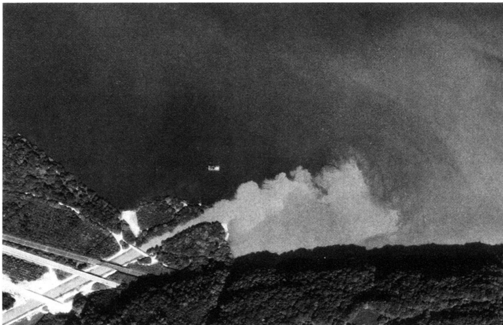
Fig. 9. Luftaufnahme der Linthmündung bei starker Trübung (Abfluss etwa 70 \text{ m}^3/\text{s} ). Die Ablenkung des Mündungsstrahls nach rechts ist deutlich zu erkennen. Aufnahme der Eidg. Landestopographie, 2. Juni 1978.
