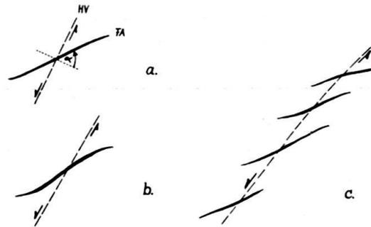
Fig. 3. HV-Faltung: a) Beziehung zwischen dem Verlauf der Faltenachse und Verschiebungssinn und Streichen der Horizontalverschiebung.  $\alpha$  = Auslenkungswinkel. FA = Faltenachse. HV = Horizontalverschiebung. b) Schleppung der Faltenachse über der Horizontalverschiebung. c) En échelon Anordnung von HV-Falten über einer Horizontalverschiebung im Untergrund.
