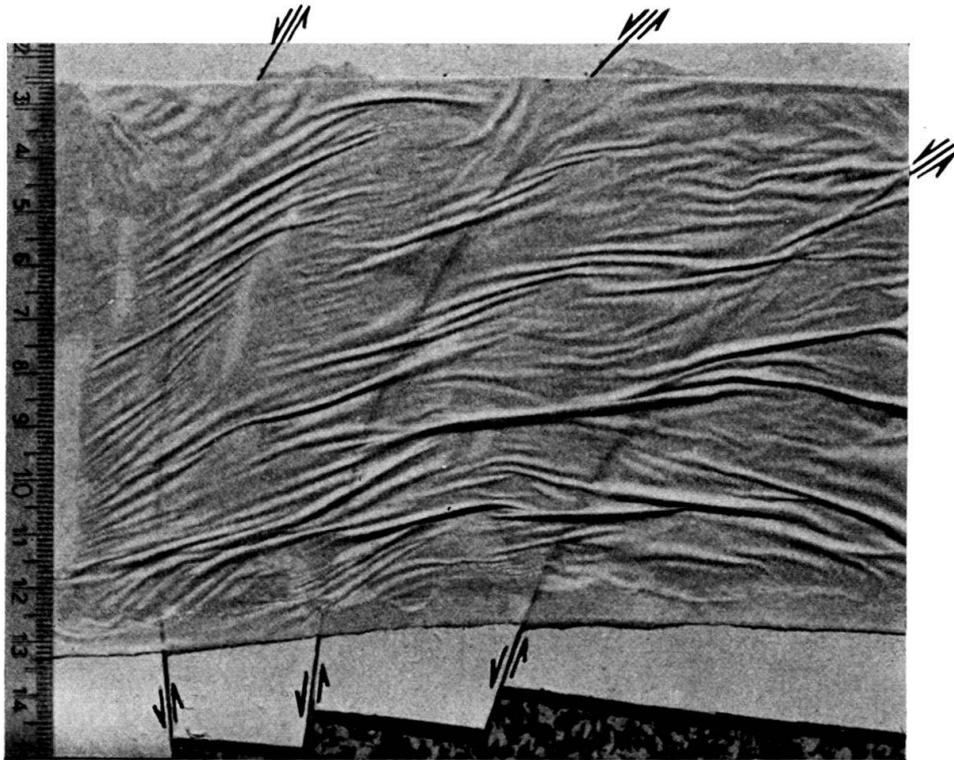
Fig. 2. Faltung durch Horizontalverschiebung im Experiment. Hauchdünnes, nasses Papier über 0,5 mm mächtiger Schicht von Mehlpappe. Masstab in Zentimetern.
