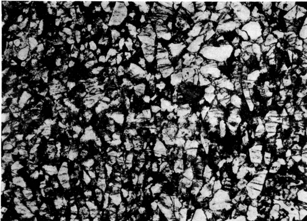
Fig. 20. Dünnschliff aus der unmittelbaren Nachbarschaft der Schnittebene von Fig. 19 mit verschiedenen Bewegungs- und Schersystemen. Durch die Bildmitte verläuft (von unten nach oben) die unscharfe Grenze zwischen einem grobkörnigen, helleren Bezirk (rechts) und einem etwas feiner gekörnten, dunkleren (links). 30 \times .
