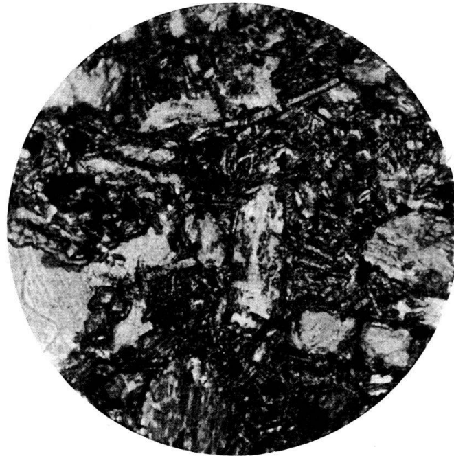
Fig. 2. Dünnschliffbild des Basaltes von Ramsen. Grundmasse aus Augitleisten. Mitte: Melilithkristall. Links unter der Mitte: karbonatische Blasenfüllung. Rechts unter der Mitte und unten: Olivine. Einf. pol. Licht. Aufnahme F. Hofmann.
