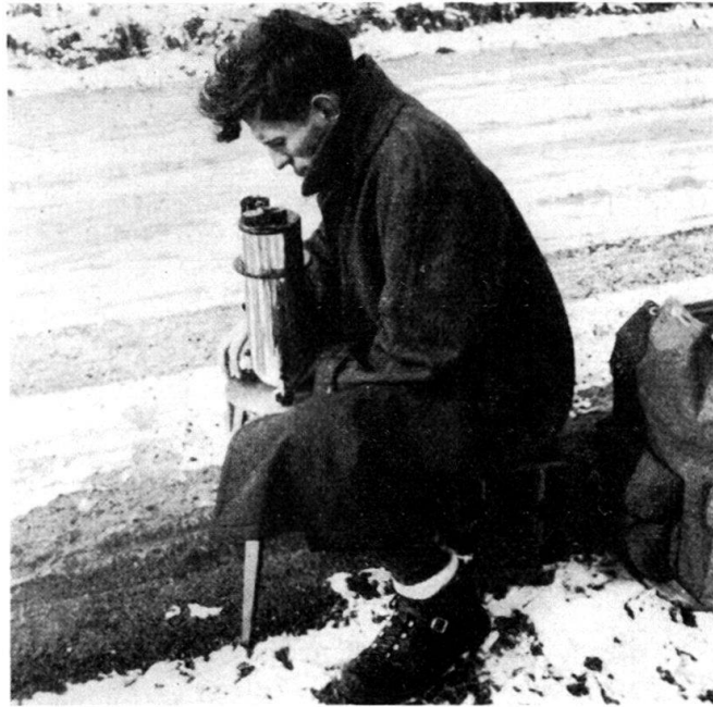
Fig. 1. Das Worden-Gravimeter während der Messung auf einer Feldstation.
