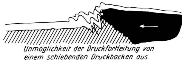
Fig. 2. Geringe Druckfortleitung durch das zu wenig druckfeste Gestein an der Front einer vordringenden Kontinentalplatte (schwarz). Schema.
