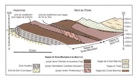
Fig. 3. Coupe schématique à travers les unités penniques en Valais, au sud du Rhône, modifiée d'après Steck et al. (2001, planche 3, coupe 2). Tracé de la coupe: voir figure 2.
