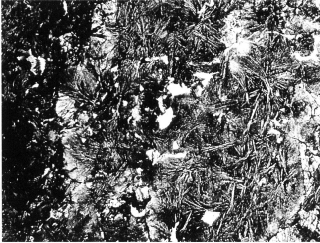
Fig. 2. Detail aus einem hyaloklastischen Pillowrand (Figur 1). Linker Bildrand: Feinster Meta-Hyaloklastit bestehend aus Chlorit, Serizit, Titanit und Hämatit; Bildmitte und rechter Rand: Die arboreszierenden Strukturen bestehen aus einem feinen Gemisch von radialstrahligem Albit und Chlorit, sowie Aktinolith oder Pumpellyit und Titanit. In den Zentren liegen Mikro-Phänokristalle von Albit mit unterschiedlichen Wachstumsstufen. Die dunklen Aggregate bestehen aus Chlorit, Hämatit und Titanit sowie grösseren Calcitkristallen. Bildbreite 8 mm.
