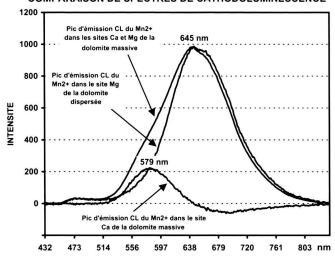
Fig. 7. Comparaison des spectres d'émission en cathodoluminescence de rhomboèdres de la dolomite massive (forage 702, 171,35 m) et de rhomboèdres dispersés dans la craie (forage 701, 556,30 m). Les rhomboèdres de la dolomite massive se distinguent par une faible émission à 579 nm correspondant à l'émission du Mn<sup>2+</sup> dans le site du Ca.
