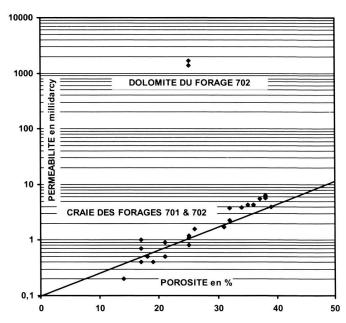
Fig. 5. Mesures de perméabilité en fonction de la profondeur dans les forages Poigny 701 et Sainte-Colombe 702. On remarque la forte perméabilité de la dolomite massive et la diminution de la perméabilité de la craie avec l'augmentation de la profondeur.
