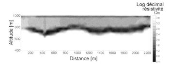
Fig. 4. Profil des résistivités électriques déduites des mesures CS-AMT de la vallée des Ponts (de Brot-Dessus à Martel Dernier)
