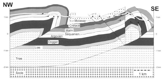
Fig. 6. L'une des trente-trois coupes utilisées pour construire le modèle 3-D de la vallée des Ponts. Cette coupe suit le tracé de la ligne sismique. L'interprétation en profondeur jusqu'au socle est basée sur les travaux de Sommaruga (1997)
