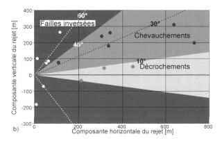
Fig.10. Présentation graphique des rejets de failles mesurés sur le modèle 3-D de la vallée des Ponts, (a) Pendage du rejet en fonction de sa norme. (b) Composante horizontale du rejet en fonction de sa composante verticale.
