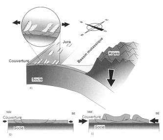
Fig. 11. Modèle de la formation des plis du Jura. (a) Extension due à la flexion de la lithosphère. (b) Plissement du Jura d'abord par l'inversion des failles normale héritées (c) puis développement de grands chevauchements s'encrant sur un décollement dans les évaporites du Trias.
