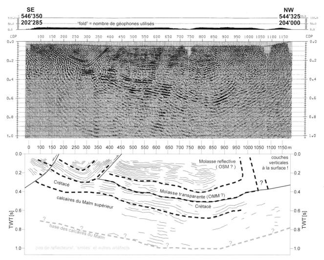
Fig. 5. Ligne sismique levée par l'ETHZ en 1996 et son interprétation.
