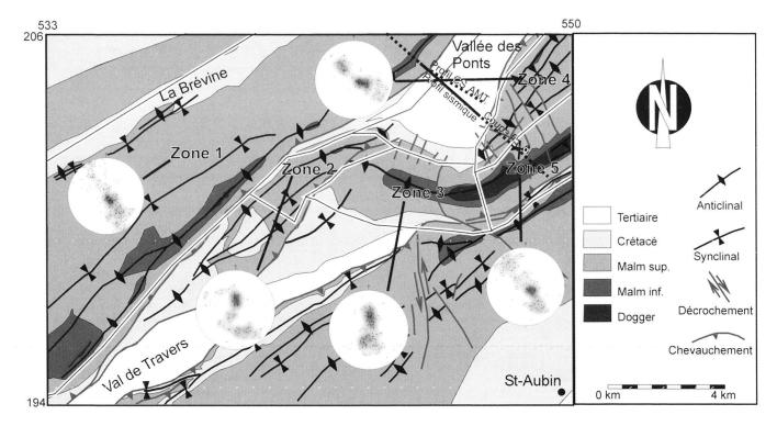
Fig. 3. Présentation des mesures d'azimut–pendage de la stratigraphie menée sur les structures avoisinant la Vallée des Ponts. Les stéréogrammes sont des projections de Schmidt-Lambert (aire égale), hémisphère inférieur. L'aperçu géologique de fond est tiré de Sommaruga (1997). Les profiles géophysiques et la coupe géologique sont également localisés sur cette carte.
