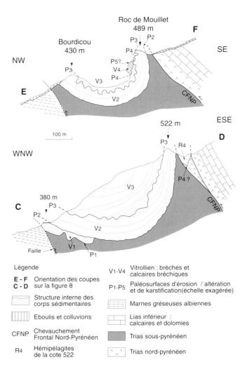
Fig. 9. Coupes géologiques à travers l' «écaille de Cucugnan» (localisation sur la Fig. 8) montrant la superposition des corps bréchiques vitrolliens (V1-V4) et des paléosurfaces (P1-P4) à la Bouzole et au Roc de Mouillet.
