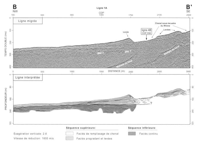
Fig. 3. Profil sismique 1A migré et son interprétation géologique. Cette figure montre les sismofaciès bien contrastés des deux séquences sédimentaires dans la partie supérieure du delta Rhône ainsi que la discordance qui les sépare. Pour la position du profil voir la figure 2.
