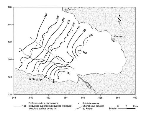
Fig. 6. Carte de la profondeur du toit de la séquence sédimentaire inférieure. La conversion temps-profondeur a été effectuée avec une vitesse moyenne de 1600 m/s. La comparaison avec la bathymétrie du lac (Fig. 2) permet d'estimer l'épaisseur de la séquence supérieure. Au nord du chenal principal actuel, on observe un paléo-sillon séparant deux surélévations à 150 et 160 m.
