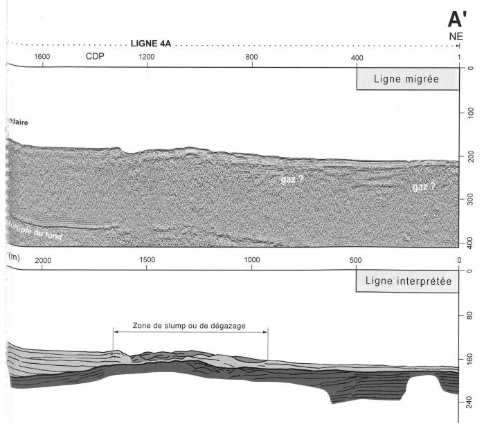
Fig. 4.Profil sismique 4 migré et son interprétation géologique. On remarque sur ce profil les fortes variations d'épaisseur de la séquence supérieure du delta du Rhône. Le sismofaciès chaotique entre 900 et 1600 m peut être interprété comme résultant de slumps ou, alternativement, comme le résultat d'un dégazage des sédiments. On observe la présence de plusieurs chenaux entaillant la séquence supérieure. Pour la position du profil voir la figure 2.
