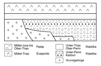
Fig.12. Schematische Entwicklung des Ablagerungsraums bei Reaktivierung prä-existenter Verwerfungen im Grundgebirge. Der vertikale Versatz ist meist gering und äussert sich aufgrund plastischer Deformation von Evaporiten des Muschelkalks meist in flexurartigen Verbiegungen des Meeresbodens.
