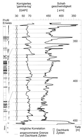
Fig. 13. Dachbankzyklen im Opalinuston im Aufschluss Eriwies (links; nach Allia 1996) und in der Nagra-Bohrung Riniken (rechts), wie sie anhand geophysikalischer Messungen (Weber et al. 1986) ausgeschieden wurden. Das gamma-'log' zeigt Veränderungen im Tongehalt und eine mehr oder minder gut entwickelte dachbankzyklische Gliederung, das 'sonic log' Sandgehalt und Zementation.
