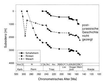
Fig. 9. Zeit-Tiefen-Verlauf der Grenze Sediment-Grundgebirge in den Bohrungen Riniken, Weiach und Schafisheim unter Berücksichtigung der Kompaktion.
