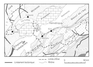
Fig. 4. Esquisse tectonique de la Vallée du Rhône (Extrait de l'esquisse géologique de la Suisse, Landeshydrologie und Geologie, BUWAL). La vallée du Rhône entre Brig et Martigny suit l'axe de la ligne tectonique du Rhône—Simplon. Cette ligne définit la séparation entre le domaine géologique constitué par les unités Helvétiques, Ultra-Helvétiques, Autochtones et Parautochtones au nord et le domaine géologique Pennique et Austroalpin au sud.
